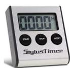
Stylus Timer, misuratore tempi di utilizzo della testina o della puntina del giradischi.
