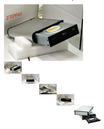
Box esterno - attacco IDE- per masterizzatore IDE, autoalimentato. Adatto anche per HD IDE .
